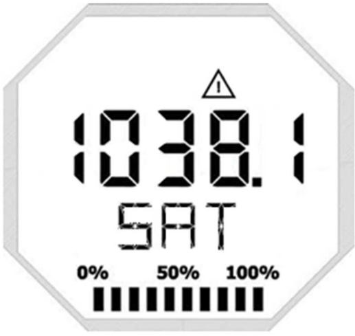
Figura 3.13 – Indicação de saturação da medição.
