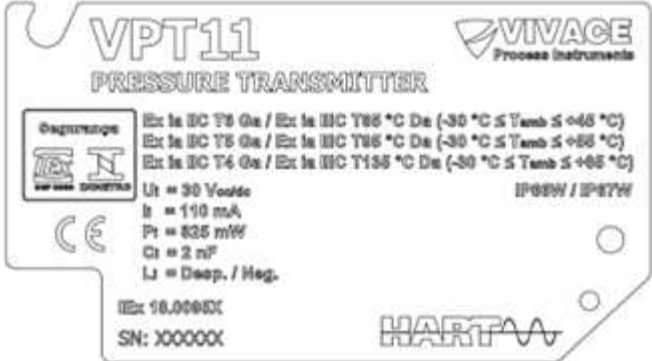
Figura 5.2 – Plaqueta Ex ia do VPT11 HART padrão.
